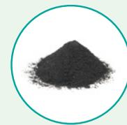
触媒層はプラチナを担持させたカーボンで構成されています。当社技術により、プラチナのサイズと配置を均等化することで、効率よく化学反応を起こし、発電性能を向上させています。
